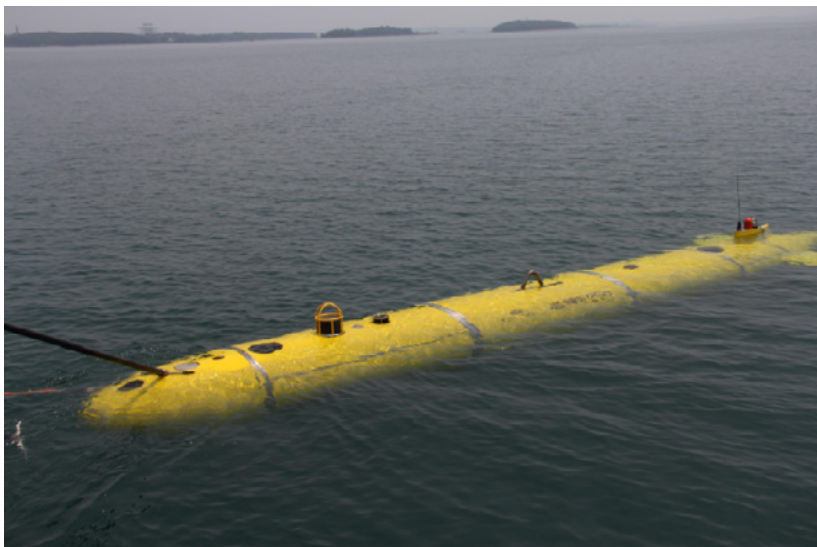
Imagen N° 2: Haishen 6000, el AUV (vehículo submarino autónomo) chino más grande.
