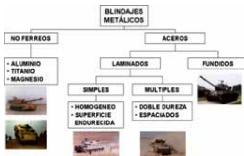
Figura N° 2: Clasificación de los blindajes metálicos.
