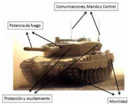
Figura N° 1: Elementos fundamentales en la composición de un vehículo de combate.
