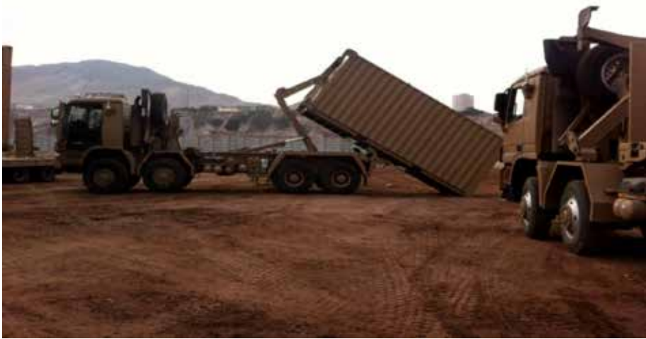
“Camión polibrazo del proyecto Yareta, que podrá ser usado en el transporte del módulo de mantenimiento”.
