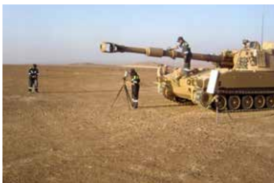
Figura N° 6: Verificación realizada por personal de IDIC, mediante un radar basado en efecto Doppler, de la velocidad en la boca de una munición 155 mm disparada por una pieza autopropulsada. Fuente: Instituto de Investigación y Control.
