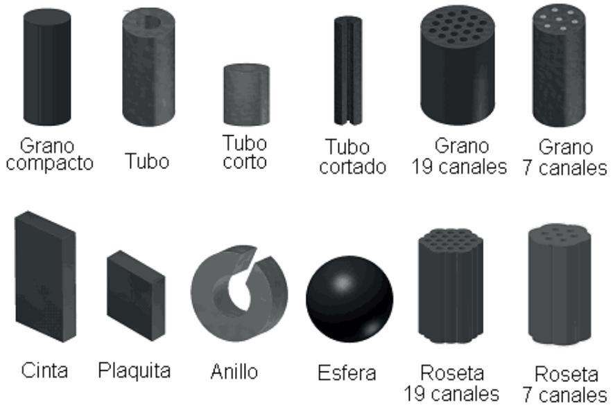
Figura N° 3.10. Formas de granos del propelente para municiones
