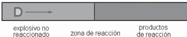
Figura N° 2.1. Onda de detonación
