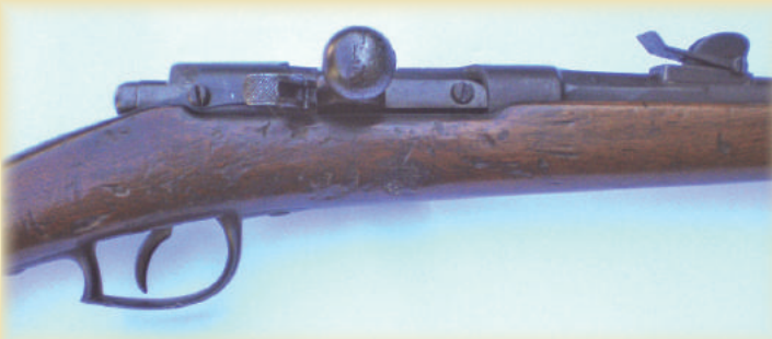
Cajón de los mecanismos y alza.
