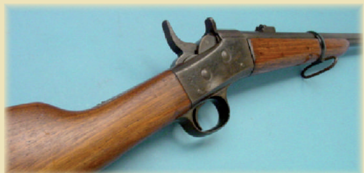
Culata, cajón de los mecanismos y argolla portaarma.
