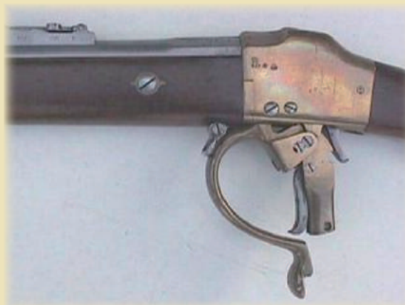
Cierre de prisma vertical, en posición de preparación.
