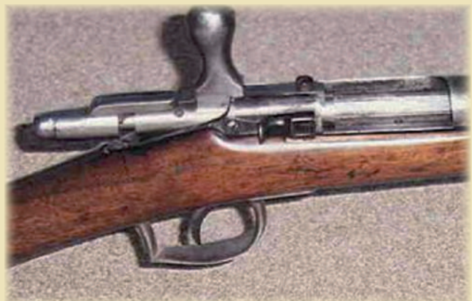
Cierre de cerrojo, en posición de preparación.
