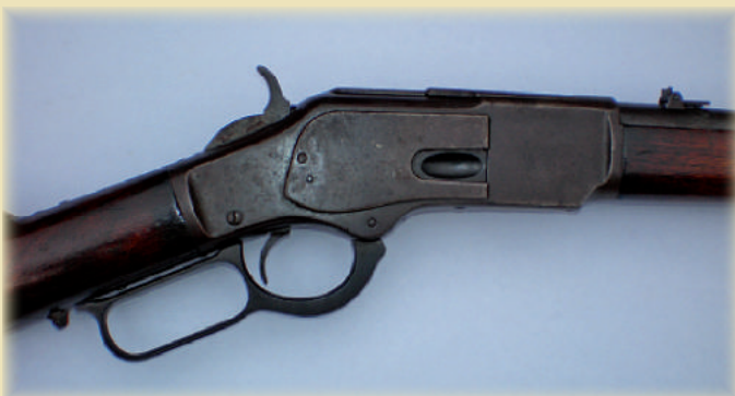
Caja de los mecanismos y alza, vista desde el lado derecho.
