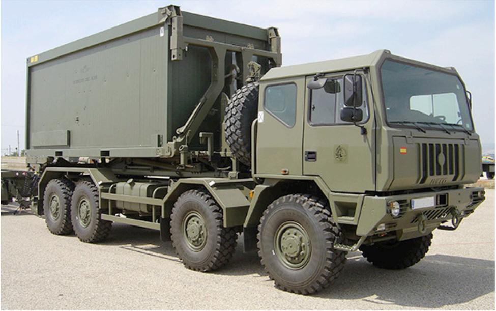
IMAGEN N.º 5. CAMIÓN CON CABINA DE MANDO Y CONTROL Y SIMULACIÓN DESMONTABLE Y ADAPTABLE A OTROS VEHÍCULOS.
