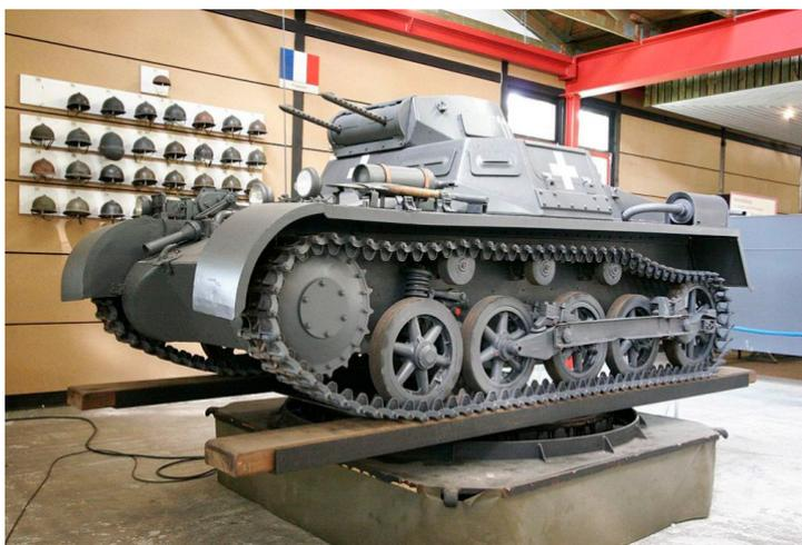
Figura N°4: “Panzer I”, tanque de entrenamiento de las tropas acorazadas, basado en la maqueta del tanque Carden Lloyd MK IV británico, construido a partir de 1932. Inicialmente estaba diseñado como tanque de reconocimiento y tareas de apoyo a la infantería.
