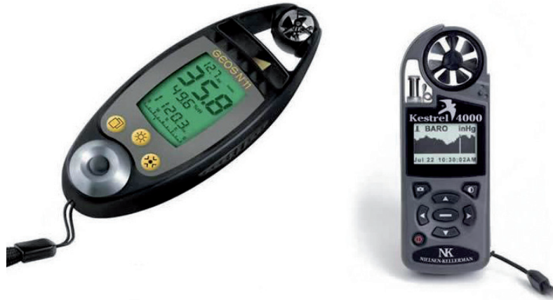
Fig. 5 Estaciones meteorológicas portátiles Geos 11 y Kestrel 4000 para la medición de las variables en terreno.
