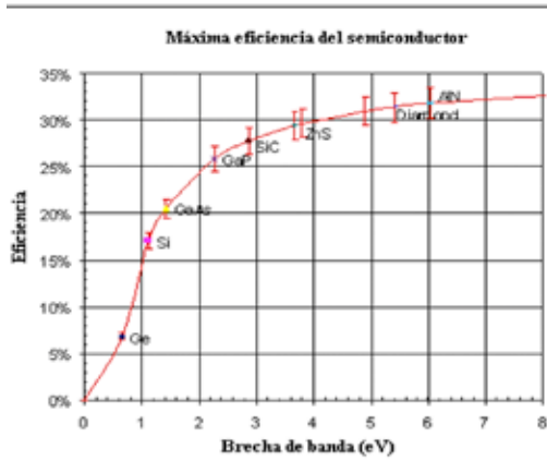
Figura N° 17. Dependencia de la eficiencia betavoltaica teórica v/s ancho de banda del semiconductor [3,4].
