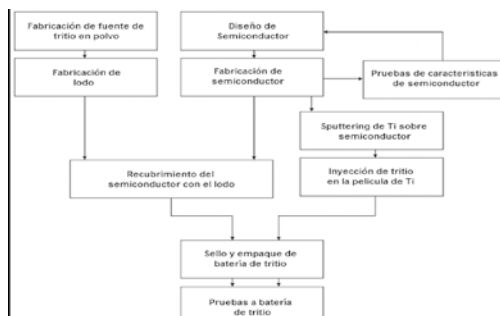
Figura N° 18. Flujo de fabricación de baterías betavoltaicas base tritio.
