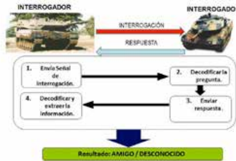
Figura N° 1 Esquema de interacción interrogador-interrogado para identificación del vehículo.
