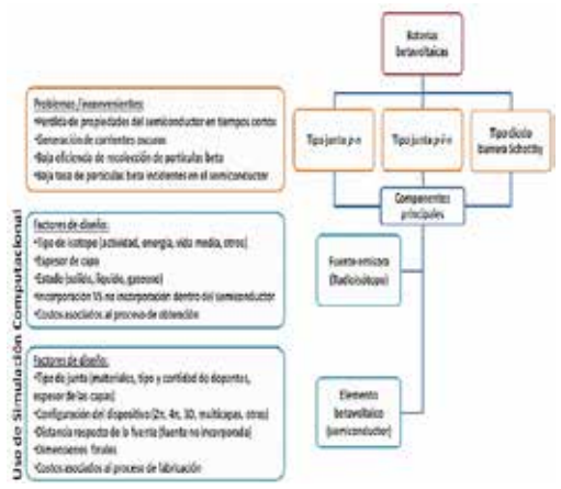
Figura N° 3. Clasificación, inconvenientes y factores de diseño de baterías beta-voltaicas [12].
