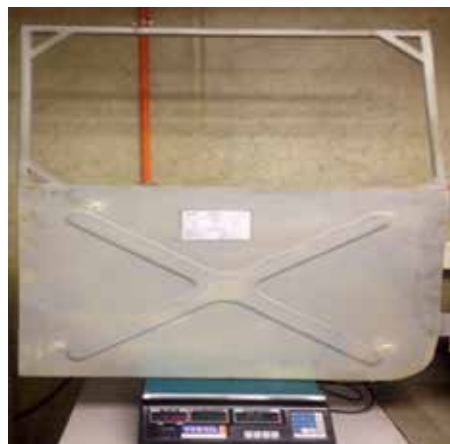
Figura N° 12: Puerta blindada del Humvee.
