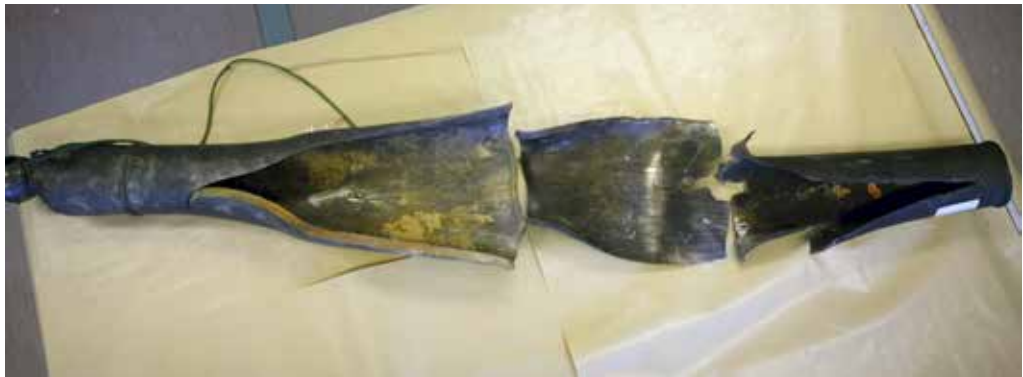
Figura N° 12: Tubo de mortero 120 mm objeto de accidente por DC en Rovajärvi, Finlandia, Dic.2005 (Photo: © Safety Investigation Authority Finland). [7]
