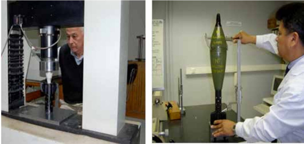
Figura N° 1: Personal de IDIC realizando, como parte de un peritaje de morteros: a) la simulación del efecto de comprimir la cabeza de una espoleta contra el culote del cartucho central de una granada y b) la determinación de las dimensiones de una munición.
