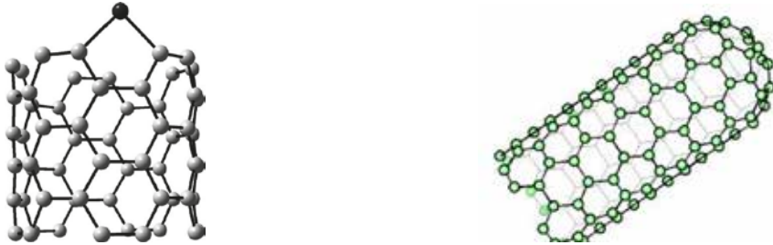
Figura N° 11: Una ilustración del mecanismo de “scooter” para el crecimiento de un NTC (10, 10) asistido por un átomo de Ni quimisorbido en el extremo abierto del NTC.
