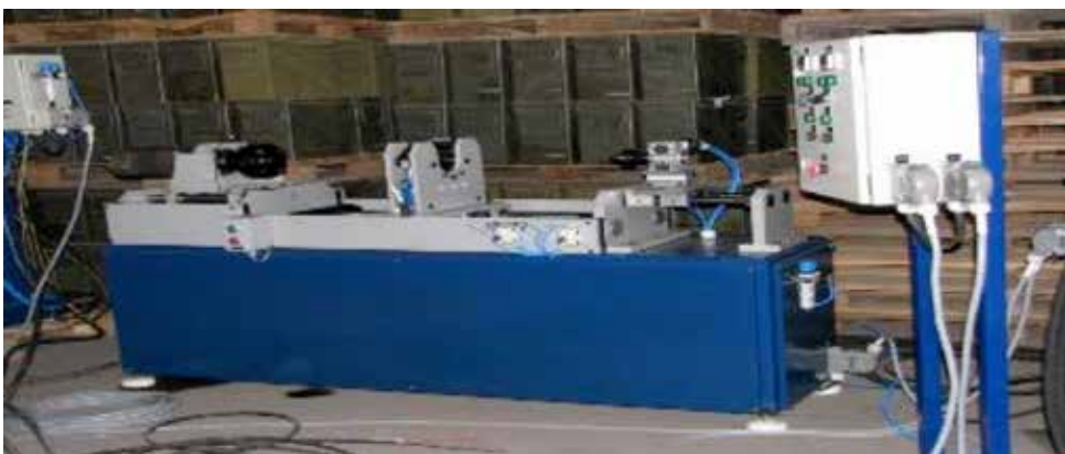
Figura N° 3: Máquina para desarme de elementos atornillados de municiones de calibre mayor.
