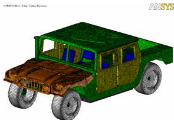
Figura N° 17: Mallado del vehículo Humvee. Malla de 400.000 elementos finitos.
