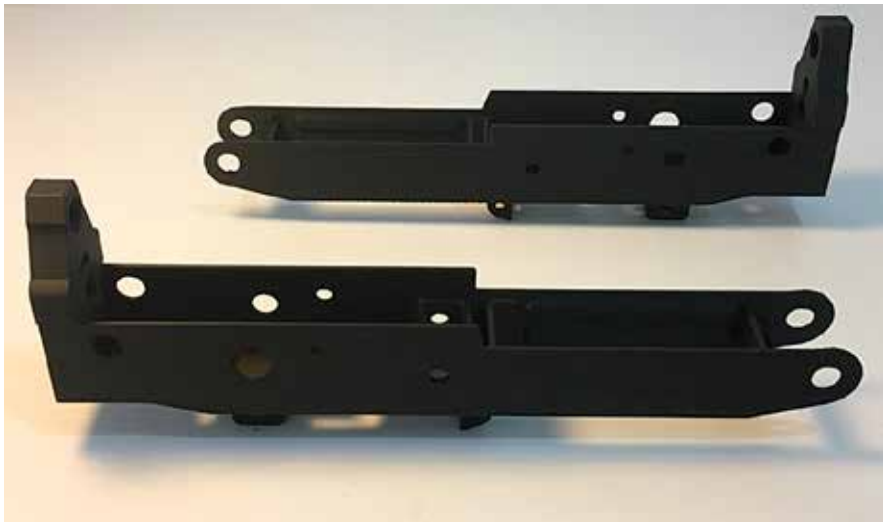
Figura N° 17: "Imagen prototipos impresión 3D en Onyx".
