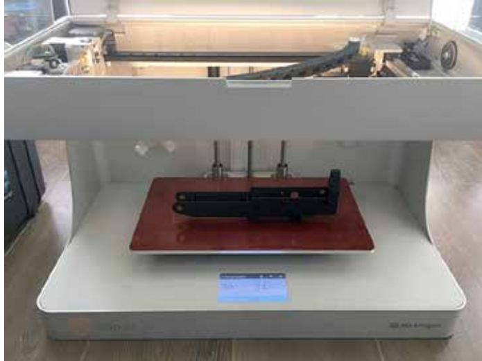
Figura N° 16: "Prototipo impresión 3D en Onyx, impresora Markforged".
