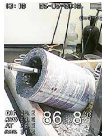
Figura N° 35: "Temperatura exterior del crisol de cemento normal". Fuente: archivo del autor.
