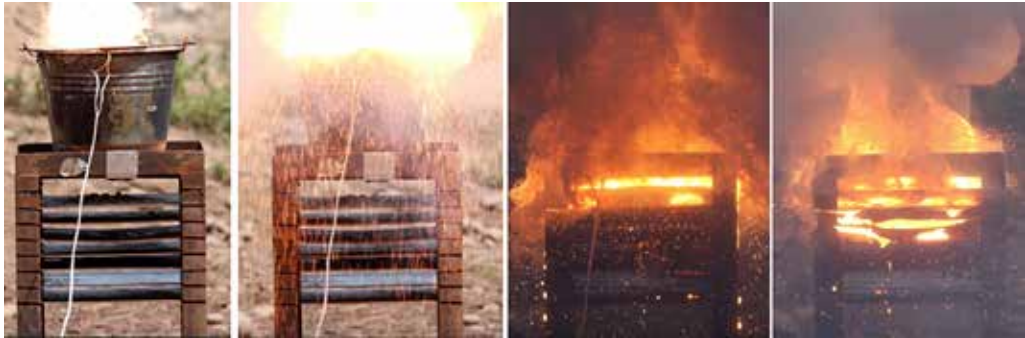
Figura N° 48: "Secuencia fotográfica de la prueba de perforación, se aprecia como el hierro líquido perfora las placas y deflagra el explosivo".
