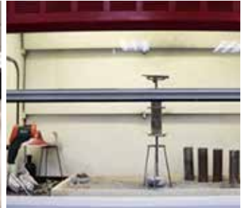
Figura N° 28: “Probeta metálica de 5 mm de espesor”.
