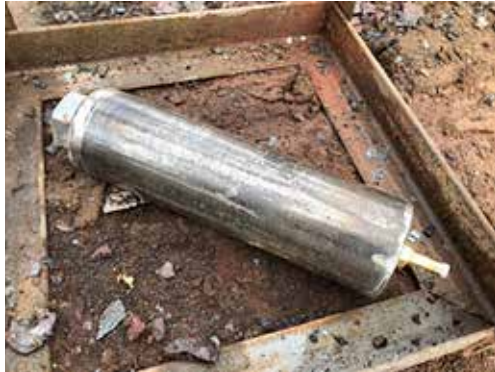
Figura N° 50: "UXO simulada de 5 mm de espesor".
