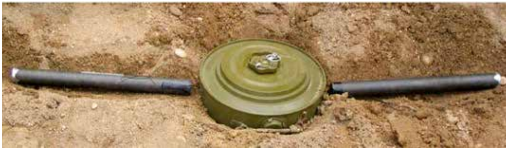
Figura N° 8: "Sistema Pyro-Torch contra mina antitanque TM-46".
