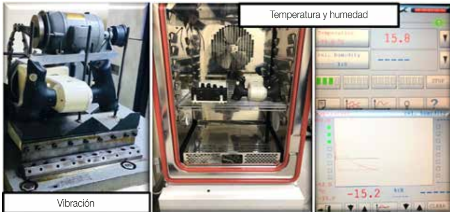
Figura N° 27: "Pruebas de vibración, temperatura y humedad".
