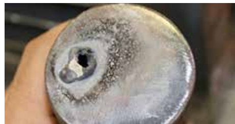
Figura N° 30: “Vista de la base perforada”.
