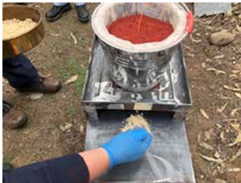
Figura N° 46: "Introducción de pentolita entre las placas".
