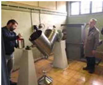
Figura N° 41: "Introducción de elementos reactivos en el mezclador".
