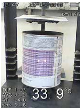
Figura N° 34: "Temperatura exterior del crisol de cemento refractario". Fuente: archivo del autor.
