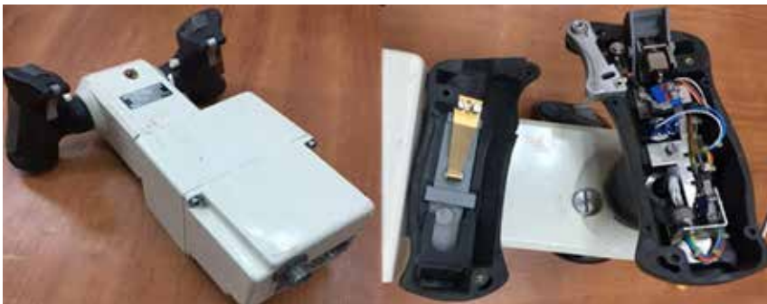
Figura N° 16: “Empuñaduras del mando, vista interior”.
