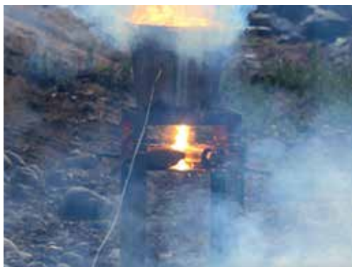
Figura N° 52: "Hierro líquido sobre la UXO a escala".
