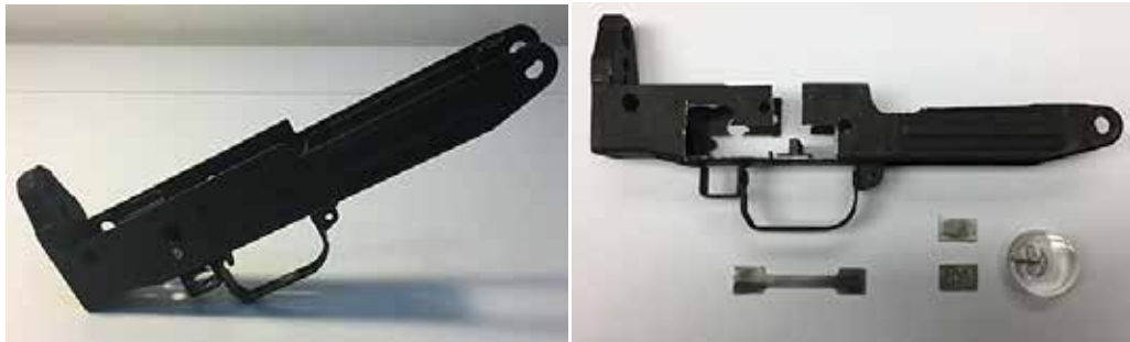
Figura N° 1: "Probetas para ensayos mecánicos SG 542-1".
