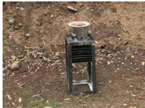
Figura N° 47: "Crisol con el sistema de ignición instalado".
