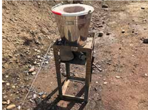
Figura N° 51: "UXO simulada situada bajo el crisol".
