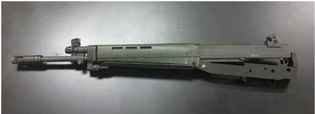
Figura N° 18: "Ajuste prototipo impresión 3D en Onyx con fusil SG 542-1".
