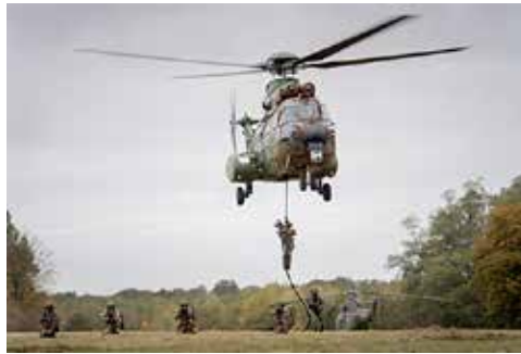
H215M "Cougar", capacidad: 4 tripulación + 18 tropa. (Fuente: www.airbus-helicopters.com ).
