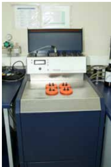
Figura N° 4: Micro-calorímetro (Heat Flow Calorimeter, HFC) del Laboratorio de Materiales Energéticos, IDIC, empleado para el análisis de la estabilidad de material energético.
