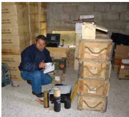
Figura N° 7: Levantamiento de registros de temperatura, realizado por IDIC, desde un sensor ubicado en el interior de una munición simulada ( dummy ) almacenada como testigo en un polvorín.
