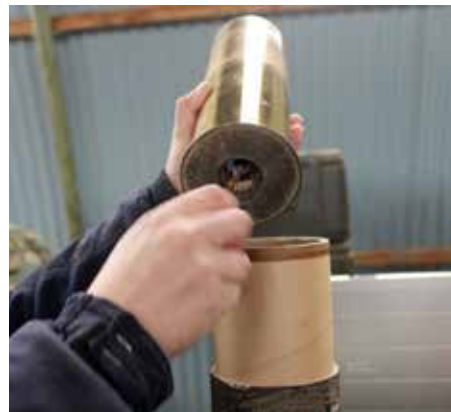
Figura N° 7: Levantamiento de registros de temperatura, realizado por IDIC, desde un sensor ubicado en el interior de una munición simulada ( dummy ) almacenada como testigo en un polvorín.
