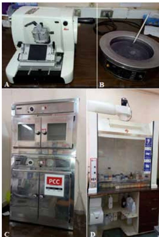
Figura N° 2: Equipamiento de laboratorio, para realizar el corte histológico del bloque parafinado y tinción final para la detección de Cryptosporidium spp. en tejidos del marisco.
