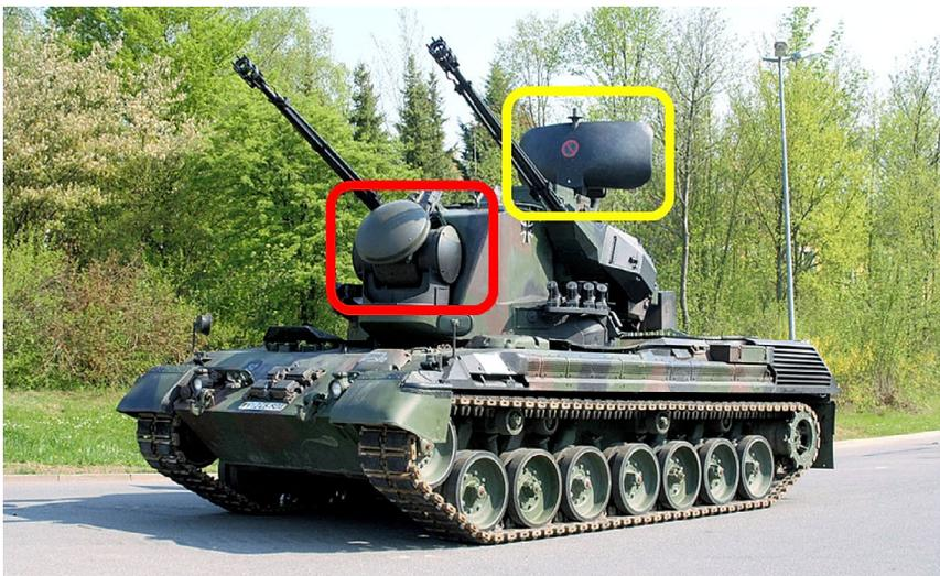
Figura N° 5: Vehículo autopropulsado antiaéreo Gepard. Esta plataforma cuenta con un radar de búsqueda MPDR-12 que funciona en la banda E (amarillo) y un radar de dirección de fuego que funciona en la banda J (rojo). Fuente: [https://es.wikipedia.org/wiki/Flugabwehrkanonenpanzer\\_Gepard](https://es.wikipedia.org/wiki/Flugabwehrkanonenpanzer_Gepard)
