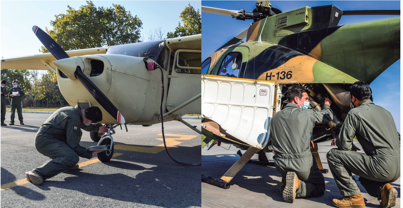
Los alumnos de ala rotatoria y fija realizan los chequeos antes y después del vuelo, tanto del avión Cessna 172 como del helicóptero MD- 530.
